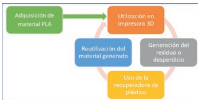
El Departamento de Electricidad, Electrónica y Automatización de Centro San Valero presenta un nuevo proyecto: una recuperadora de plástico de impresión 3D (EXTRUPLAST) que se enmarca en el concepto de economía circular vinculado a los Objetivos de Desarrollo Sostenible.
